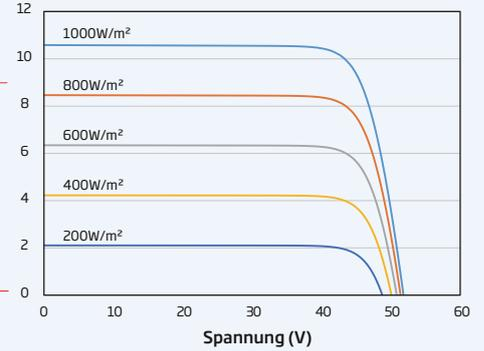
**P-V KURVEN DES PV-MODULS (440 W)**
