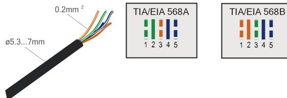
Schritt 5 Stecken Sie die Drähte in die entsprechenden Klemmen, wie in der folgenden Abbildung gezeigt.
