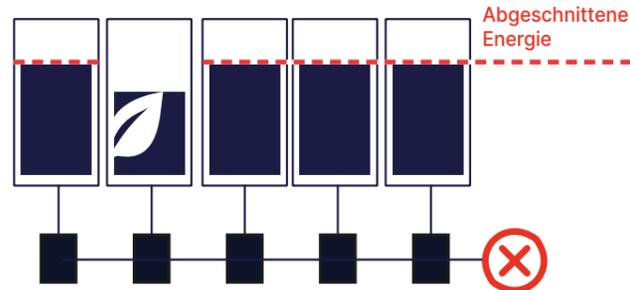
Auch Mikro-Wechselrichter ermöglichen es jedem Modul, individuell Strom zu erzeugen, allerdings ist die erzeugte Energiemenge begrenzt. Somit lässt sich nicht das Maximum aus Ihren Modulen herausholen, die Produktion von verschatteten Modulen ist eingeschränkt.
