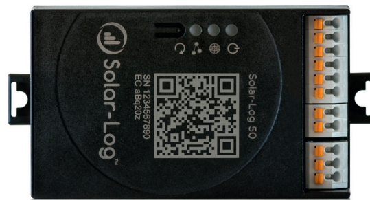
Abb.: Solar-Log 50 mit ausgezogenen Rastnasen
