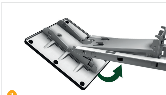
3 Bodenschuh in Aussparung bei Basic Frame einhebeln.
