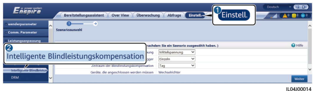
Abbildung 6-80 Einstellen der Parameter für die intelligente Blindleistungskompensierung
