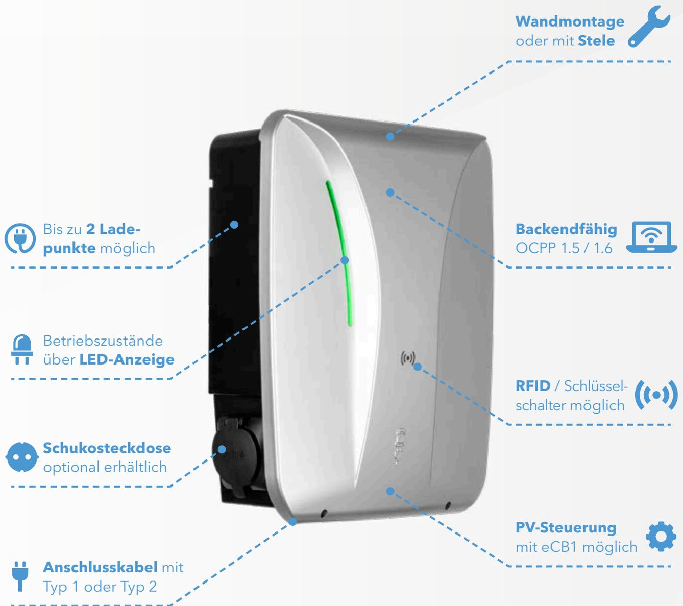
Integriertes DC-Fehlerstrom-Modul, „Smart Grid“, Ladeaufzeichnung, LAN, Energiezähler möglich in Kombination mit eCB1 Smartmeter, Schutzklasse IP44
