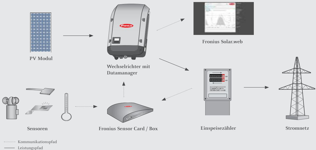
Die Fronius Sensor Card / Box bietet Eingänge für insgesamt sechs Mess-Signale.
