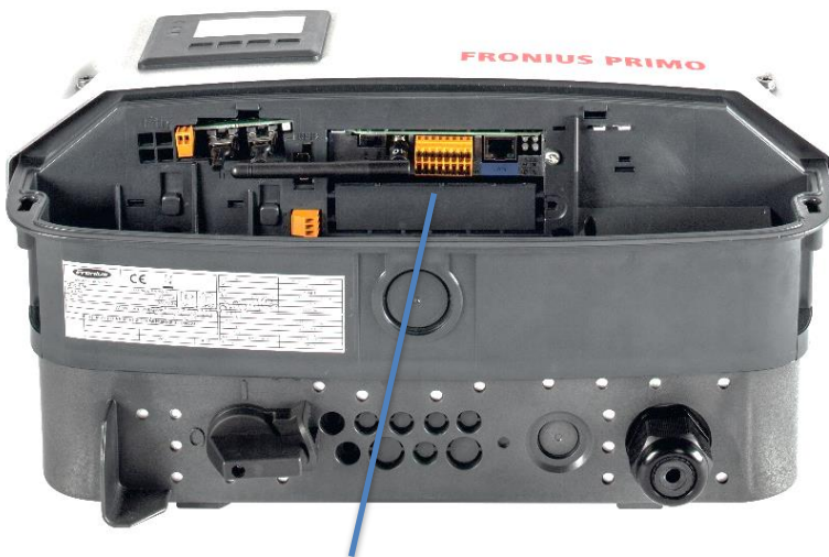
Abbildung 3: 16-poliger Stecker bei SnapINverter (Primo, Galvo, Symo, Eco). Pin IO 0-3 und GND (-) zur Relaisansteuerung verwenden.
